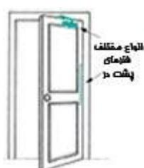
فناوهایی که به طور خودکار در را می بندند در انواع مختلفی ساخته می شوند. این فنرها با بستن در، مانع از هدر رفتن حرارت می شوند.
